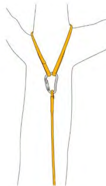
Fig. 5 - Ancoraggio della fune con dispositivo passante
